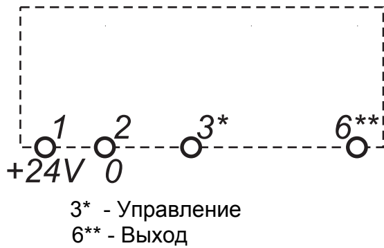
Рисунок 3 - Схема подключения реле ВЛ-63
